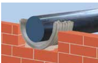
Halbschale an Medienrohr ausrichten
