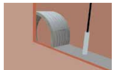
Beton im Bereich der Mauerhülse gut verdichten
