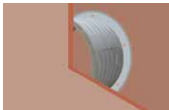
Mauerhülse in Schalung mit Schalungshilfen befestigen
