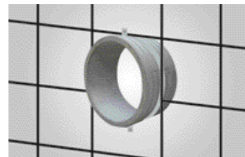
Befestigung in Stahl Schalung mit Rohrschelle verschweißt. (Rohrschelle bauseits)
