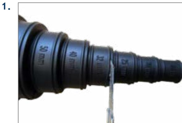
Manschette passend zur Mediumrohrgröße vorbereiten. Zwischen Markierung und dem Ende der Stufe mit einem scharfen Messer abschneiden.
