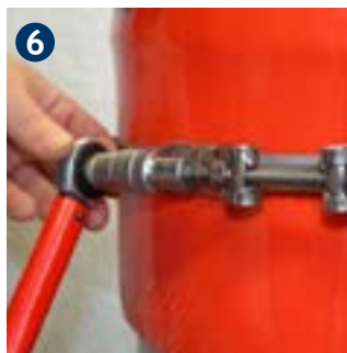
6 Spannband Ring mit Schraubverschluss festziehen (Anzugsmoment 18 NM) und nach zehn Minuten nachziehen. (Bei der Verwendung von mehreren Schraubverschlüssen auf gleichmäßiges Anziehen achten)
