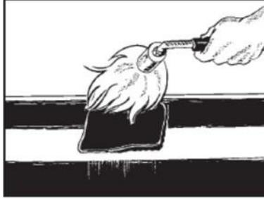
2. Positionieren Sie den vorgeschrittenen PERP-Patch über dem beschädigten Bereich und erhitzen Sie ihn, bis der Klebstoff schmilzt. Eventuelle Luftpneinschlüsse mit einer Silikonrolle ausrollen.
